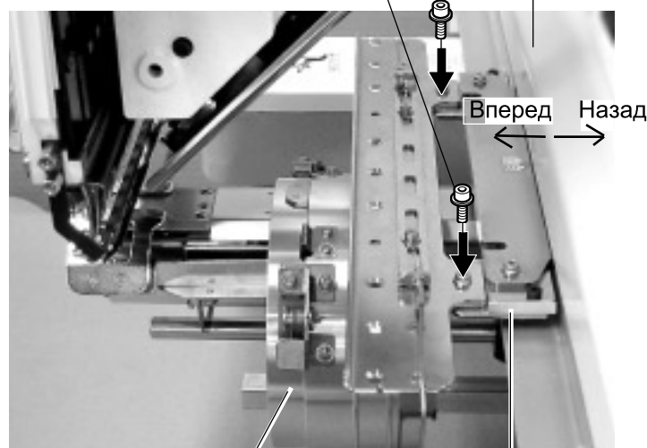
Привод кепочных пальцев Основание кепочных пальцев Рельсовый переходник
