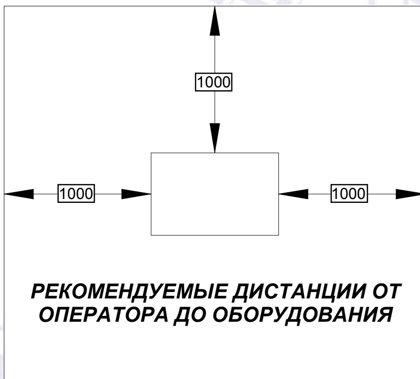
Рисунок к Главе 5.1 «Рекомендуемые дистанции до оборудования»
