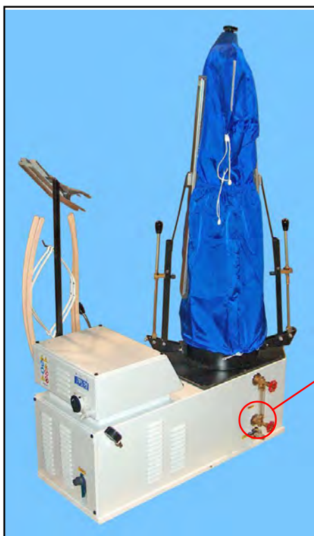
Рисунок к Главе 10.2.1 «Опорожнение бойлера»
